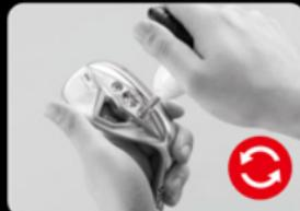
xFTスクリューを緩めると自然にxFTフェースが外れますので落ちないように注意して作業を行ってください。5回転ほど緩めてもフェースが外れない場合は、バックフェースにあるポケットからxFTフェースを指で軽く押してxFTフェースをボディから離します。それでもなお、ボディからxFTフェースが外れない場合はxFTスクリューが完全に緩みきっていないことが考えられます。再度、時計回りとは逆にxFTスクリューを数回まわしてからxFTフェースを取り外してください。
